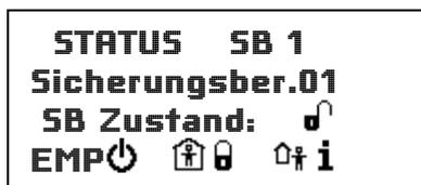
Das hier dargestellte Beispiel zeigt den Sicherungsbereich 1 in unscharfem Zustand. Die Interne Zwangsläufigkeit ist gegeben, der Sicherungsbereich kann über [lock icon] [lock icon] (F2) Intern Scharf geschaltet werden. Ist die Zwangsläufigkeit nicht gegeben, wird [lock icon] [info icon] angezeigt. Wäre keine Berechtigung zur internen Schärfung vorhanden, würde bei erfüllter Zwangsläufigkeit kein Symbol bei Taste F2 angezeigt werden.
